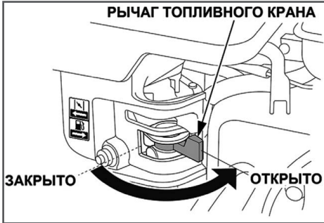
Рис. 8 Топливный кран открыт
